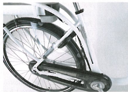
Sehr chic: Umlaufender Transparent-Kettenschutz, rahmenintegrierter Träger, Rahmenschoss und Mantelschoner. Unten: sehr schönes Alu-Display, Schnellspanner-Vorbau für leichtes Verstellen
